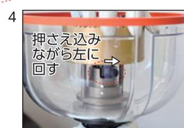
ホールソーを押しながらロック溝にロックネジが入る位置まで回しロック溝に沿って左に回して取り付け完了です。
