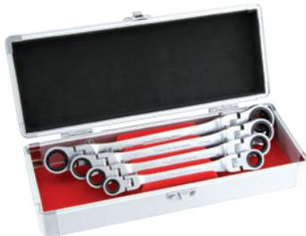
ギア数72山、送り角5度のギアにダブルフレックス機構を採用した高効率ギアレレンチ。フレックス機構は180度首振りOKで、12段階15度の角度調整で固定できる
