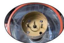
ホールソーのカス抜き穴に、本体のカス抜き棒2本を真直ぐ差込みます。
